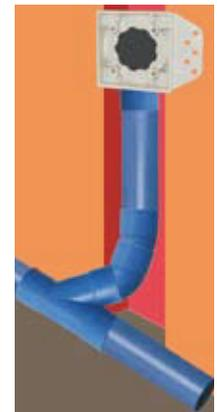
Steuerleitung einziehen und mit der Verputzabdeckung schließen.
