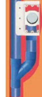
Die Montageplatte wird mit dem Mauerwerk bündig gesetzt, sie darf nicht vorstehen. Die Montageplatte ist lotgerecht zu setzen, damit die Saugdose später gerade eingebaut werden kann.
